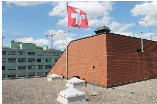
*Bild: Messstation Muesmatt mit Lärmmessmikrofon und Radarempfangsanlage*
