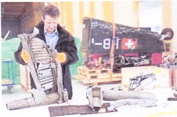
Risse und Rost: Ein Ermittler der Untersuchungsbehörde prüft ein Wrackteil der abgestürzten Ju-52 (Bild: KEYSTONE)
